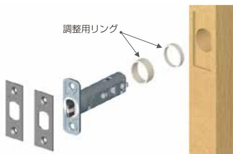
補強座の取付ねじの位置が選べるため、既存の穴に影響なく取り付けが可能。取付ねじは 8 本用意されていますので、必要に応じてご使用ください。
