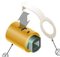
解除プッシュ②またはマイナスドライバーを図のようにレバー②裏面の穴に差し込んだ状態で角芯棒付レバー⑬を抜き取ります。
