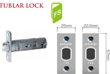
一般市場に数多く普及しているチューブラ錠。TOMFUは従来のチューブラ錠をより強化した TXS 錠を採用しています。閉じ込め防止機能(フェイルセーフ設計)で安全性も確保。(詳しくは P21 をご覧ください)取替最適品・キャラクターの TXS 錠に付属しているフロント板は、取り替えに便利な高さ 57mm で、幅は 22.5mm と 25mm の 2 枚が付属。TXS 錠はバックセット 60mm と 51mm を用意していますので、他社の製品からのお取り替えをほとんどカバーしています。
