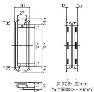
HT-MW41 (バックセット51) / HS-MW41 (バックセット38)
