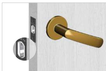
ハンドルを下げてでもラッチボルトが完全に引き込めない
