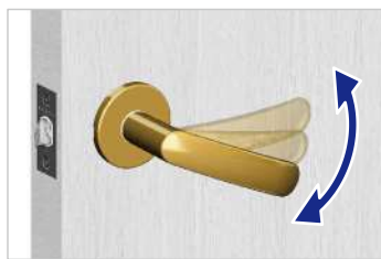
ハンドルの稼働範囲が大きくなる (正常な可動角度は25度)
